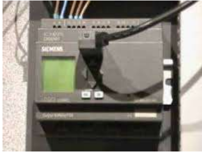
Рисунок 4.4 – Приклад програмування модуля LOGO! з комп'ютера через PC-Cable
